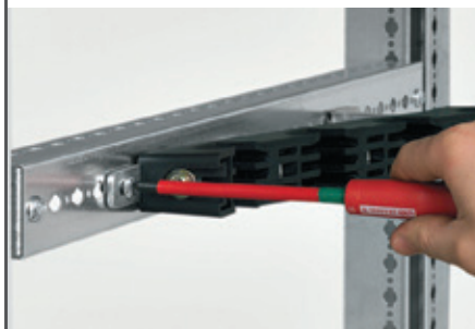
Закрепите суппорты на траверсах винтами М6 (момент затяжки 10 Н·м)
